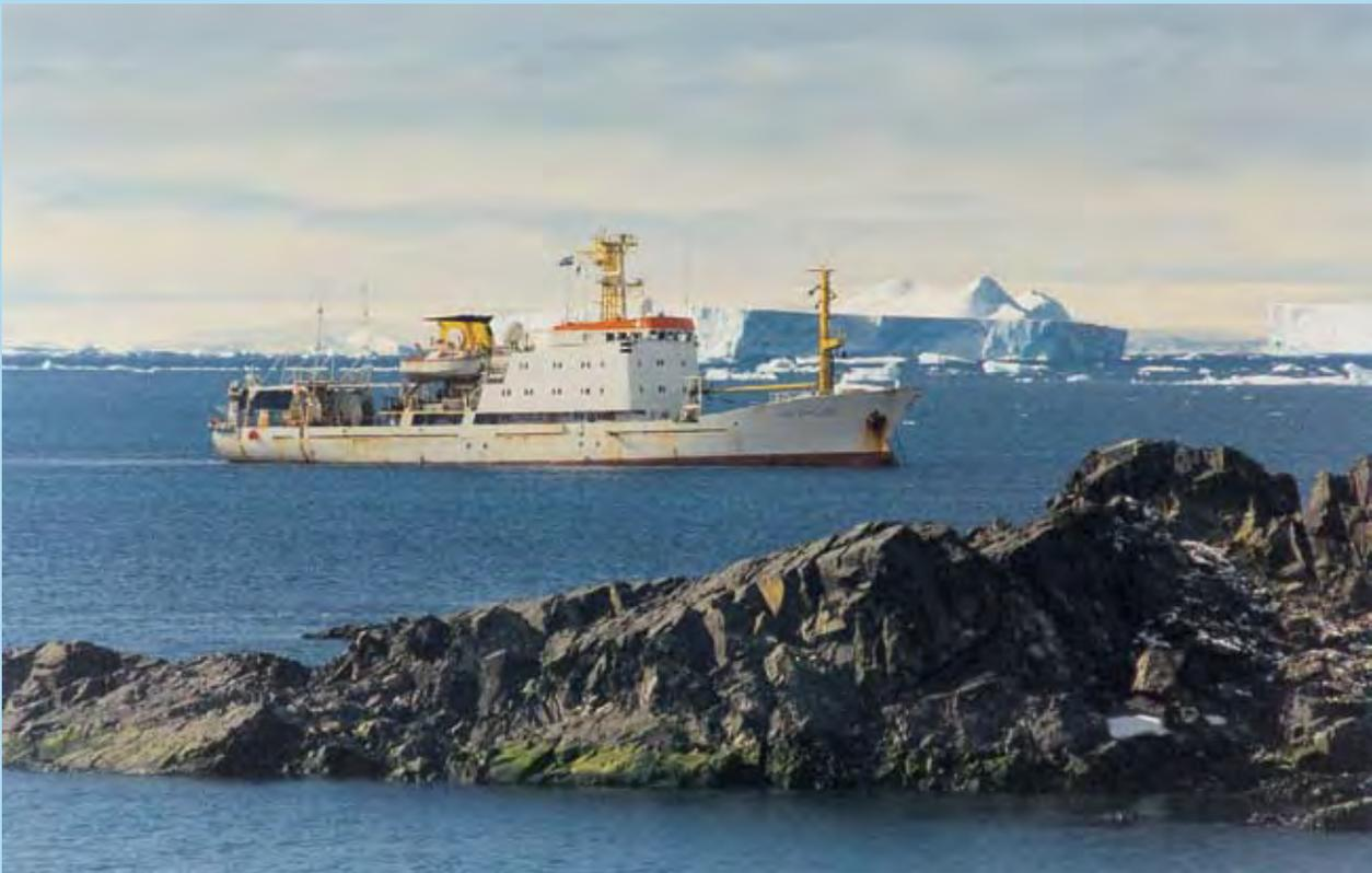
La nave geofisica OGS-Explora, attrezzata per rilievi sismici multicanale a riflessione, impiegata nel corso di numerose campagne del PNRA
