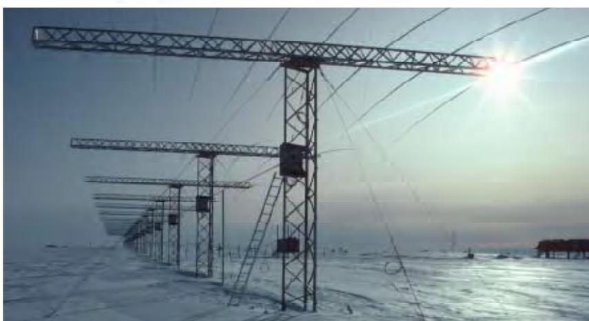
A sinistra un'immagine di un'antenna radar di un Superdarn.
