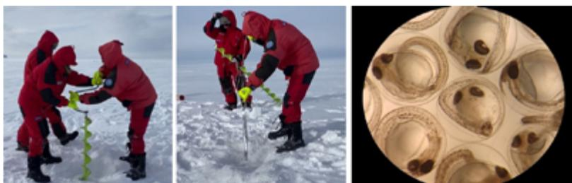
Realizzazione di fori nel ghiaccio marino mediante trivella a mano per il survey dell'area di nursery del silverfish a Terra Nova Bay (a), misurazione dello spessore del ghiaccio solido e platelet ice (b), uova embrionate di Antarctic silverfish. Principali siti di campionamento di uccelli marini
