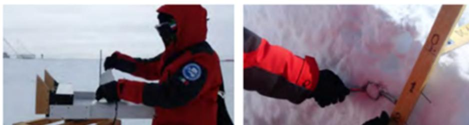
Raccolta del campione di deposizione nevosa da uno dei due banchini e prelievo di una piccola carota di neve per la misura della densità della neve.
