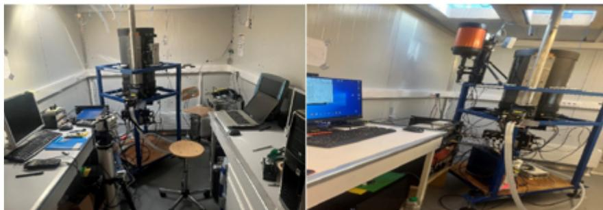
Figura 1: il sistema Lidar fino alla campagna XXXVI (sinistra) e con il ricevitore CIRCE (destra)
