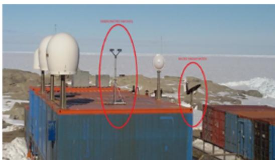
Disdrometro Parsivel e Micro Rain Radar installati sul tetto del container PAT presso la stazione Mario Zucchelli dal progetto APP.
