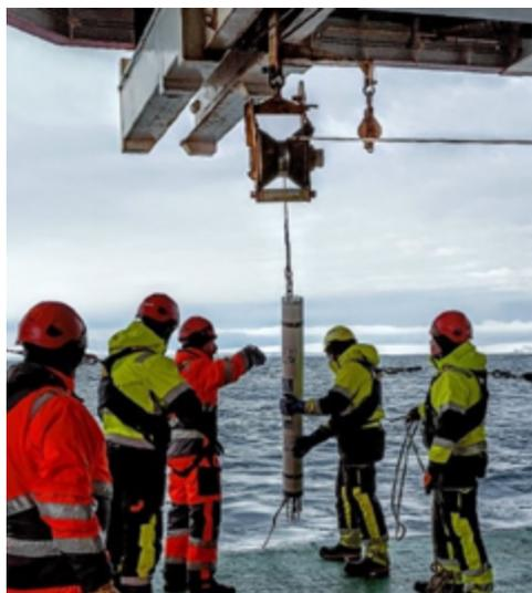
Installazione dello strumento AURAL M3 sul mooring L dell'osservatorio MORSea (foto di P. Castagno, UniParthenope).
