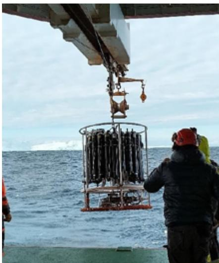
Figura 1. Momenti di raccolta di campioni: operazioni in acqua del cestello in metallo (a sinistra) e operazione di calata della rosetta per raccolta di campioni di acqua e dati ambientali (a destra).
