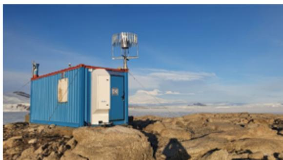
Il nuovo celiometro CL61 Vaisala ed il pluviometro a pesata montati presso il container di ELIOSISMOLOGIA nel sito di OASI
