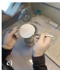
a) Campionatori HV-MET all'interno dello shelter; b) teste di campionamento sul tetto; c) operazione di cambio dei filtri.
