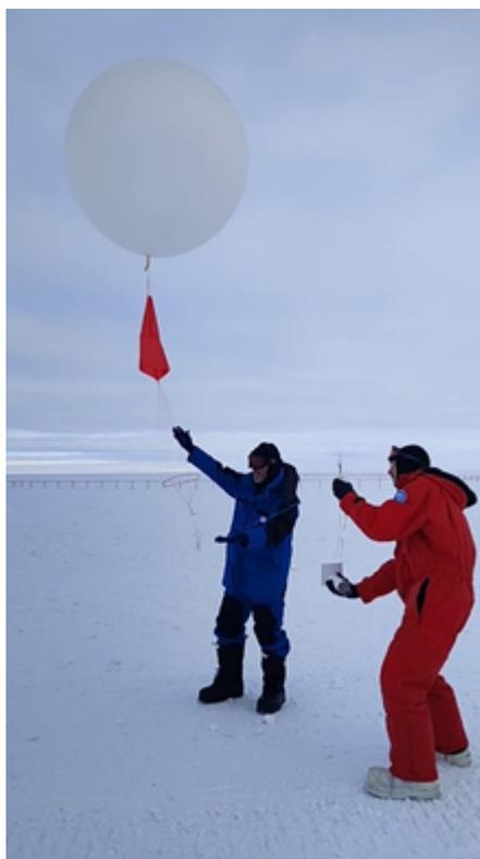
Figura 2: Lancio di un pallone sonda con sonda aggiuntiva
