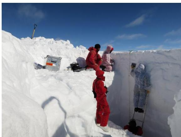
Figura AC3.03-2. Campionamento della trincea di 4,5 metri
