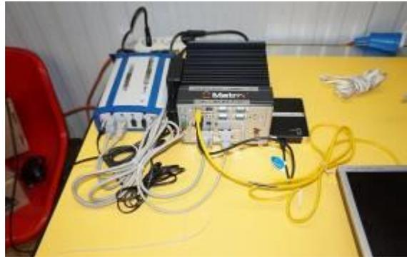
Fig. 1: Sistema di acquisizione dei dati per la nuova stazione ISACCO-DMC2 installato nello shelter
