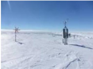
La **stazione Giulia**, situata presso Mid Point Station, è stata sollevata da un innevamento di oltre un metro. Insieme alla stazione è stato sollevato dalla neve anche il corpo batterie e sono stati effettuati nuovi cablaggi a causa del deterioramento dei vecchi cavi. Nello stesso sito è stato misurato il campo paline.
