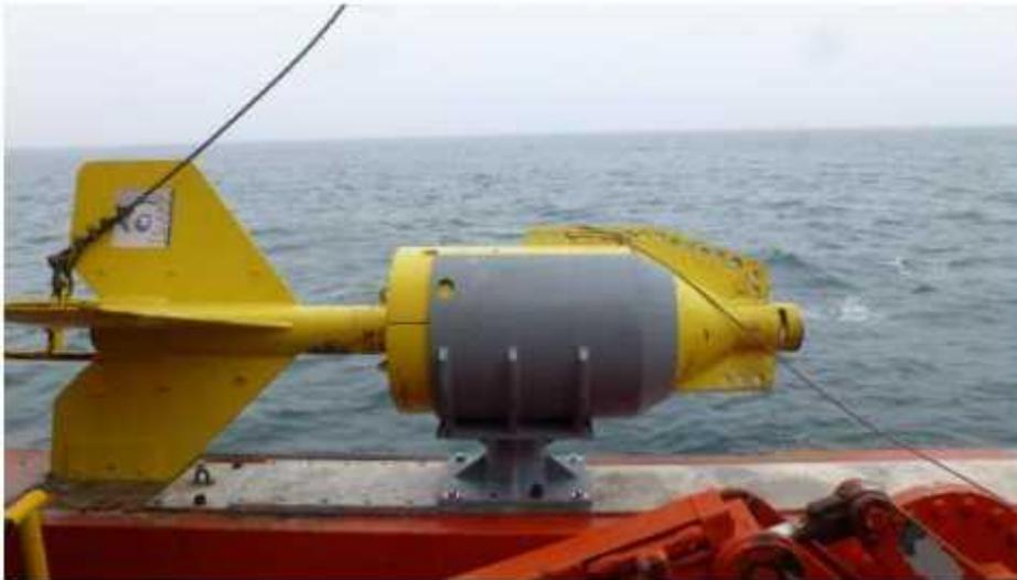
Fig. 4. Macchina brandeggiante modificata per alloggiare il carotiere a pistone CP-20 mediante apposita culla.
