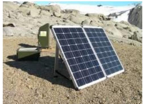
Dismessa la pista la TACMET è stata recuperata, manuten-zionata e messa in conservazione, inoltre è stato ampliato il generatore fotovoltaico della stazione per aumentare l'autonomia a 3 giorni senza sole dei sensori ottici: visibilimetro e nephoipsometro.
