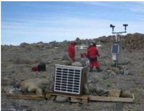
È stato montato un radiomodem sulla stazione AWS Manuela situata presso Inexpressible Island (circa 40 km di distanza) per ricevere attraverso il ponte radio del Monte Abbott i dati meteo direttamente in Sala Operativa.
