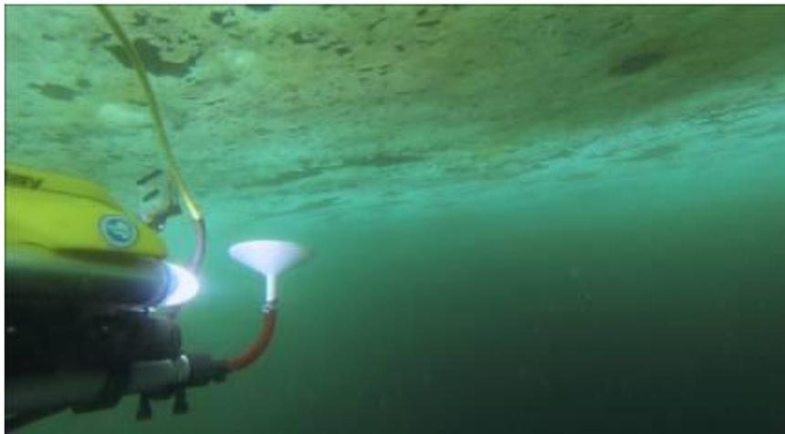
Fig. 1 – Mini-ROV VideoRay equipaggiato con “suction sampler”
