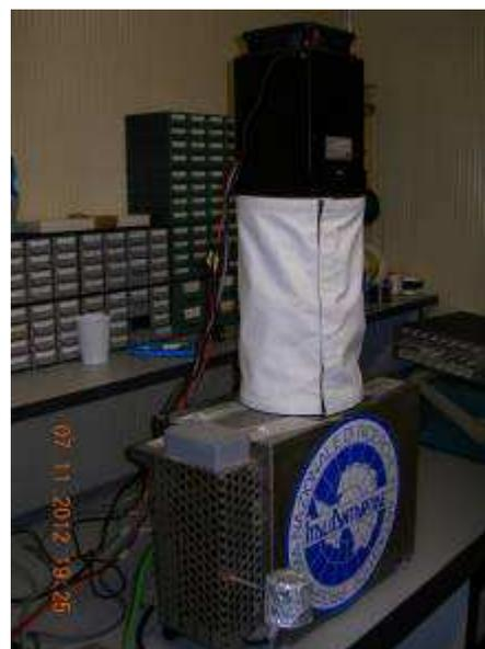
Il radiometro a filtri, installato sul tetto di OASI, ad una ispezione accurata, non ha presentato problemi di funzionamento. Attualmente, i dati rappresentano oltre tre anni di misure, con una frequenza di circa 1400 acquisizioni giornaliere, circa un'acquisizione al minuto, nell'intervallo spettrale che va da 290 a 400 nm.
