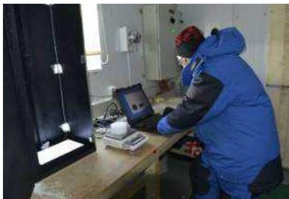
Photo 2 : Mesure de la masse d'un échantillon (cylindre de 5cm de hauteur)
