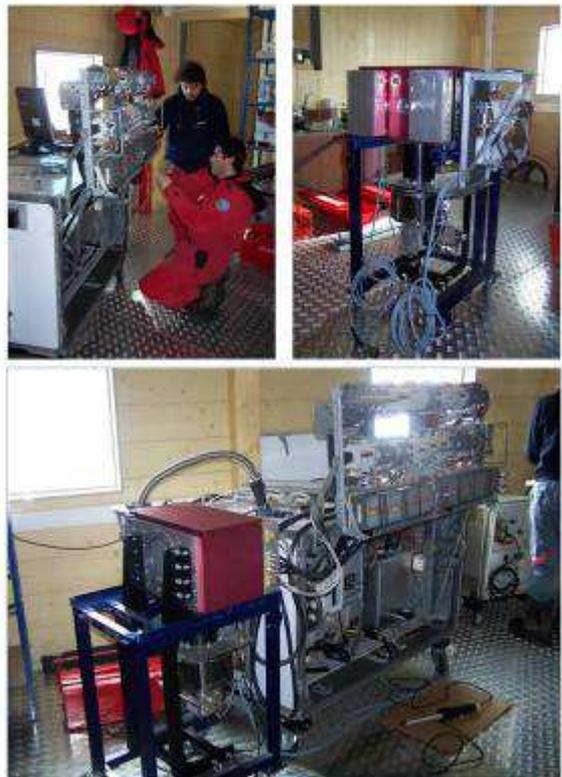
Fig. 1 – Il modulo ECS (rack bianco) ed il criostato di AMICA (box rosso) installati all'interno del WCW.
