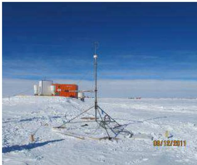
Fig. 2. Mast micrometeorologico equipaggiato di anemometro sonico e stazione radiometrica a Concordia
