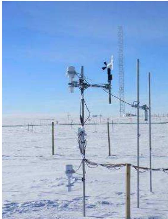
Profilage météorologique de surface ré-installé à proximité du shelter neige. Ce profilage permet de prolonger vers la surface celui de la tour visible en fond d'image.
