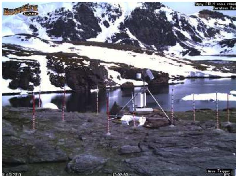
Fig. 1 - Esempio di immagine per il monitoraggio della neve registrata il 19 gennaio A Signy, in cui si può osservare anche la stazione di monitoraggio del permafrost.
