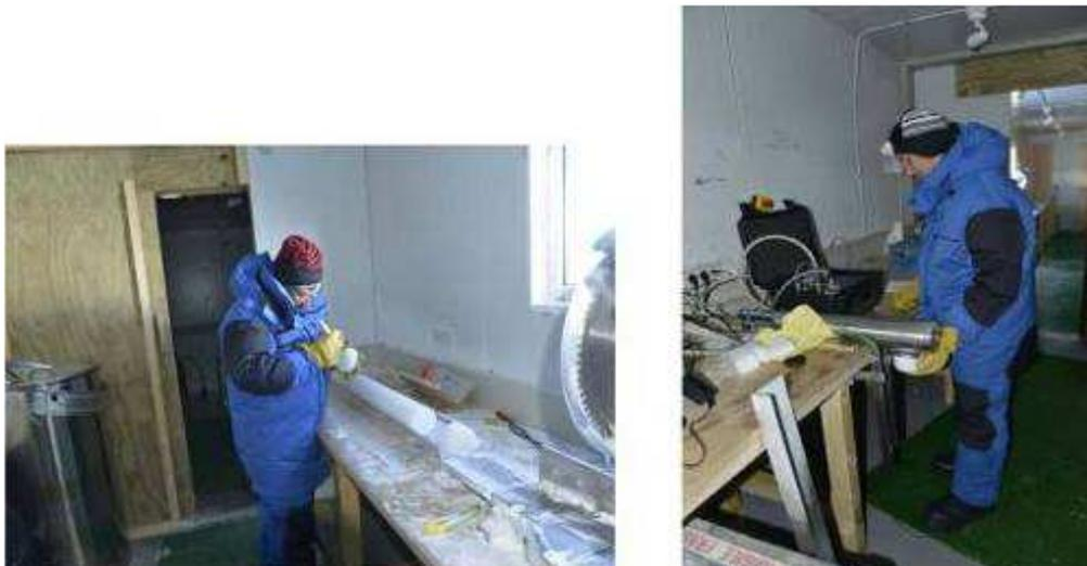
Photo 3 et 4 : Protocole de mesure de la taille de grains (SSA). Figure de gauche, nettoyage des échantillons pour enlever les copeaux dus à la découpe à la scie. Figure de droite, échantillon positionné sous les diodes de l'instrument Posssum.
