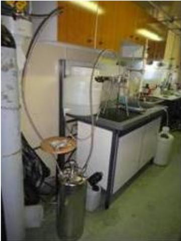
Fig. A1.1 – Sistema di trattamento delle matrici acquose
