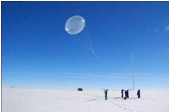
capacité de portage paraît convenable et conforme au cahier des charges, sa stabilité en vol laisse à désirer dès que le vent est significatif. Ce point sera discuté avec l'entreprise ayant fourni le ballon et une solution sera recherchée. La photo à gauche montre le ballon lancé à proximité de la tour américaine (on l'aperçoit derrière).
