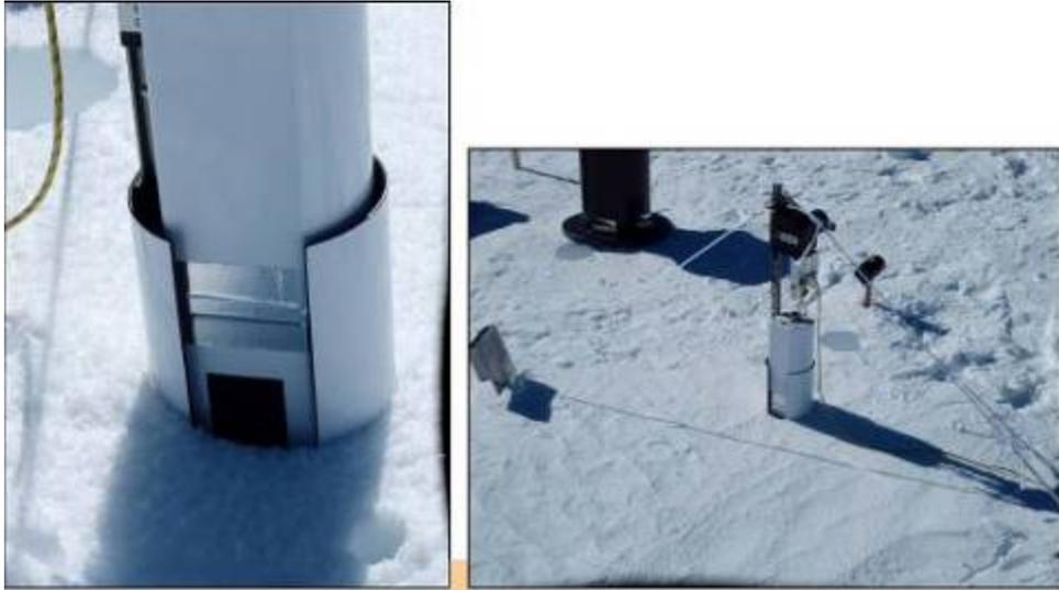
La photo ci-dessus montre ASSSIP dans le trou de forage et prêt à descendre pour la mesure de la surface spécifique.
