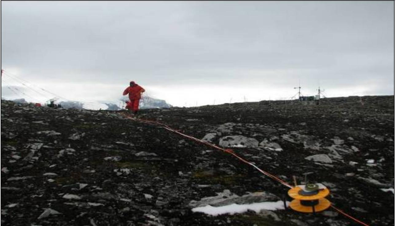
Fig- A2.8 – Rilievo geoelettrico nell'area della griglia CALM di Signy Island finalizzato alla valutazione della evoluzione dello strato attivo.
