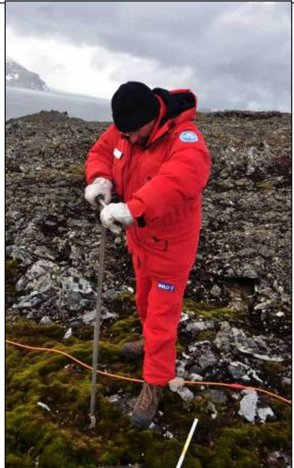
Fig. A2.10 – Esecuzione di profili pedologici attraverso l'impiego di carotatore manuale.
