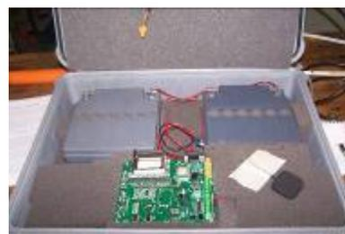
Fig. A2.4 - Scheda elettronica collegata alle batterie
