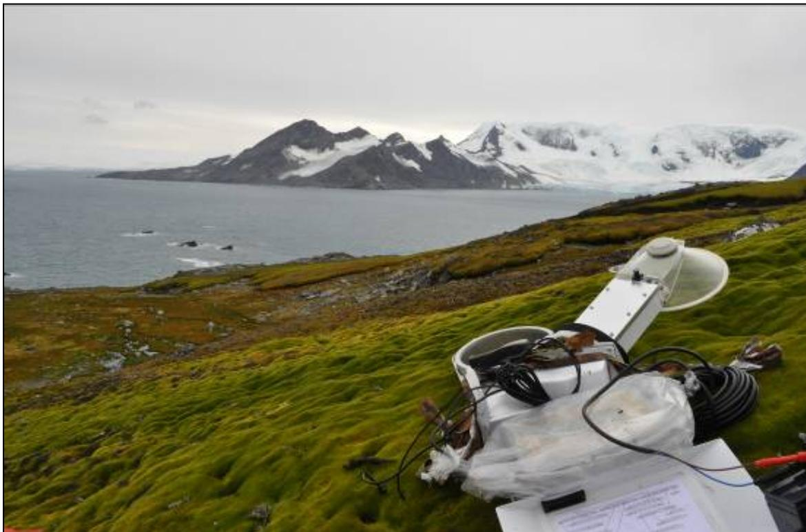
Fig.1 - Rivelatore ACE CO<sub>2</sub> al lavoro su un *moss bank lobe* presso Sprindrift Rocks (costa ovest dell'Isola di Signy)
