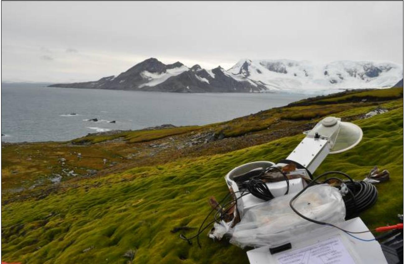
Fig.A2.12 - Rivelatore ACE CO<sub>2</sub> al lavoro su un *moss bank lobe* presso Sprindrift Rocks (costa ovest dell'Isola di Signy)
