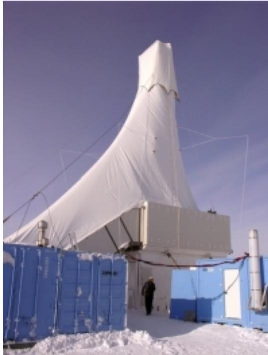
Fig. 4.2.1 - La torre di perforazione utilizzata nel progetto MIS (McMurdo Ice Shelf Project) ha permesso il recupero di c. 1285 m di carote dei sedimenti sottostanti la Ross Ice Shelf nell'area del McMurdo Sound.
