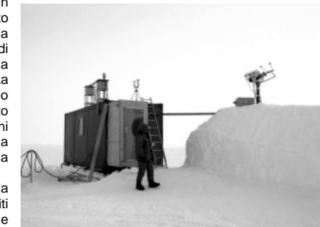
Fig. 2.4.1 - La piattaforma di neve su cui sono stati montati il *tracker*, tutti i radiometri, e il fotometro solare. Si noti che la piattaforma è collegata come potenza elettrica e segnali allo shelter.
