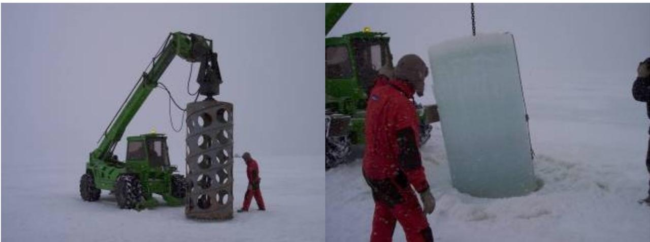
Posizionamento del carotatore oleodinamico
